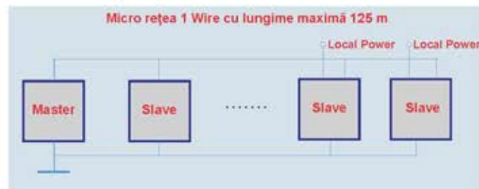
Fig. 2 Structura și dimensiunile unei rețele 1-wire
